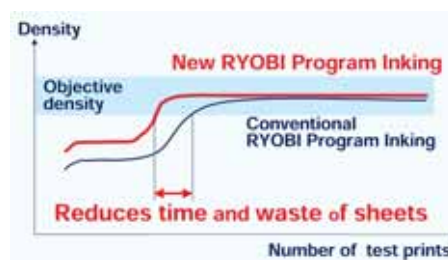
Рис. 3. Новая система RPI уменьшает время приладки и отходов бумаги
